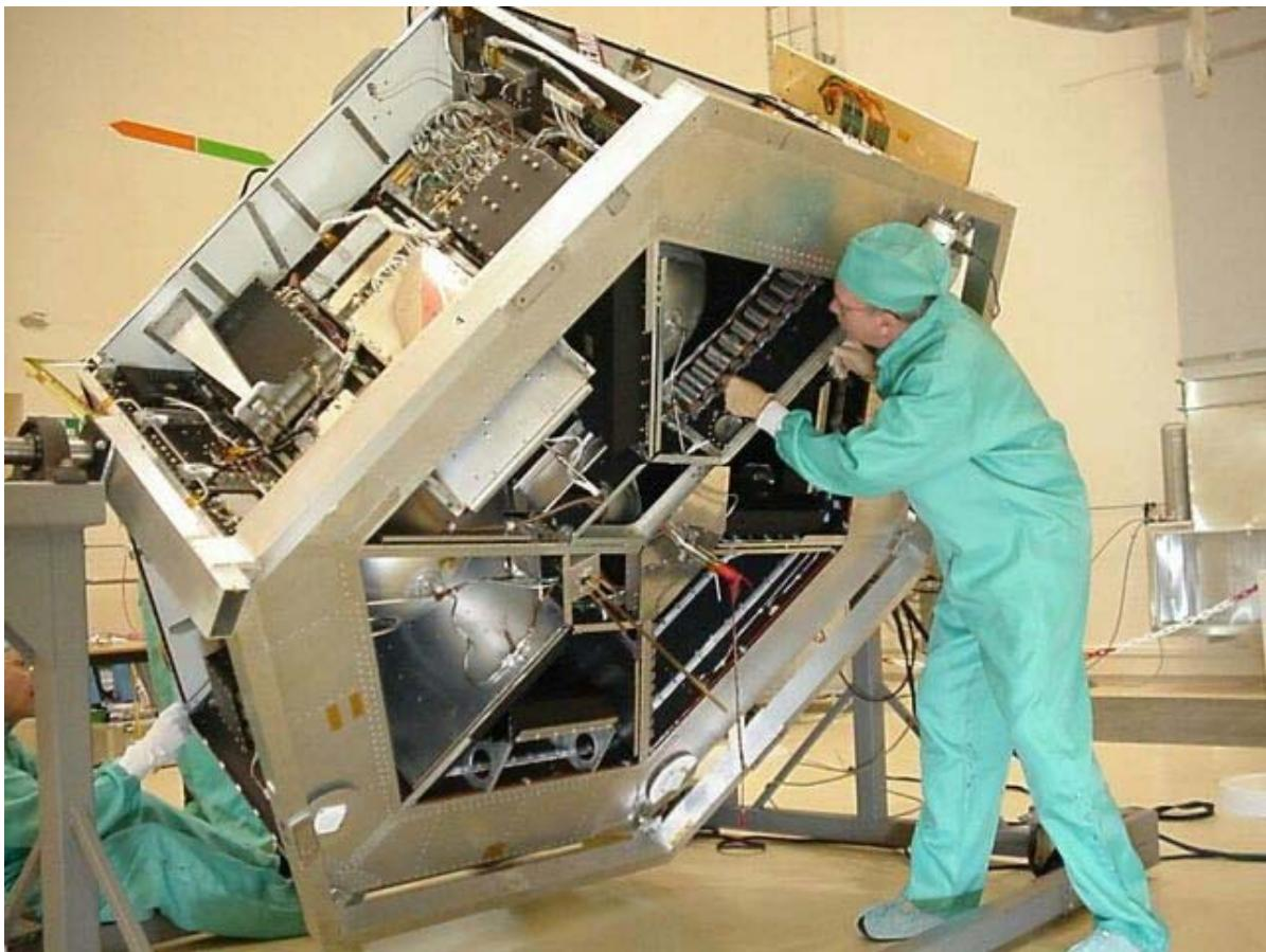
*Om vi antar att AO-40:s problem är en kortslutning i en eller flera battericeller kan man hoppas att någon av cellerna förr eller senare ”öppnar” så att resistansen i batteriet ökar så mycket att solcellerna förmår att höja spänningen till ca 14 volt.*
