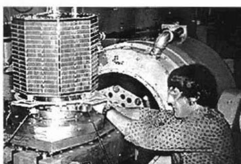
Jan King, W3GEY förbereder AO-7 för vibrationstest
