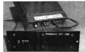
Uppkonvertern finns för både 144 och 435 MHz MF (0.01 – 1 watt), som omvandlas till ca 100 mW på 1268-1270 MHz. Denna signal går därefter (tillsammans med en 12V-spänning) in i ett speciellt Bias Tee där DC för utomhusförstärkaren anslutes. Bör vara ca 13 VDC 5A.
