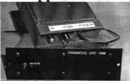
**Uppkonvertern** finns för både 144 och 435 MHz MF (0.01 – 1 watt), som omvandlas till ca 100 mW på 1268-1270 MHz. Denna signal går därefter (tillsammans med en 12V-spänning) in i ett speciellt Bias Tee där DC för utomhusförstärkaren anslutes. Bör vara ca 13 VDC 5A.
